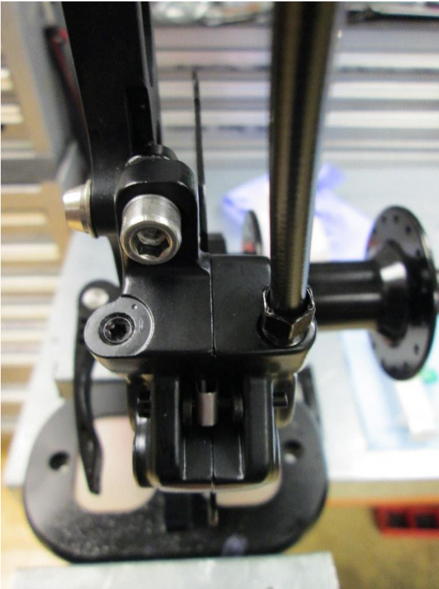
Remove T15 bleed port bolt.
